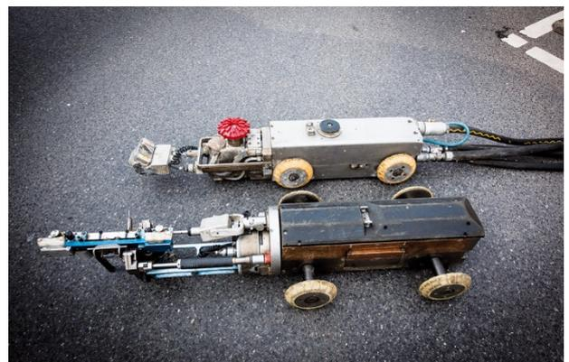
Abbildung 23: Geräte zur Kanalsanierung
