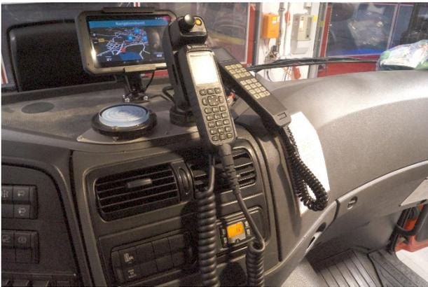
Abbildung 19: Digitalfunk im Feuerwehrfahrzeug
